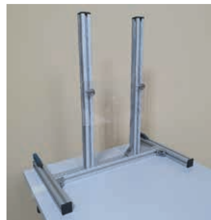
Рис. 1. Вспомогательное приспособление для измерения освещенности
